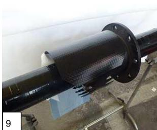
9 Manschette in der 2- oder 10-Uhr-Position mittig auf die Schutzeinlage kleben. Schutzfolie vollständig abziehen.
